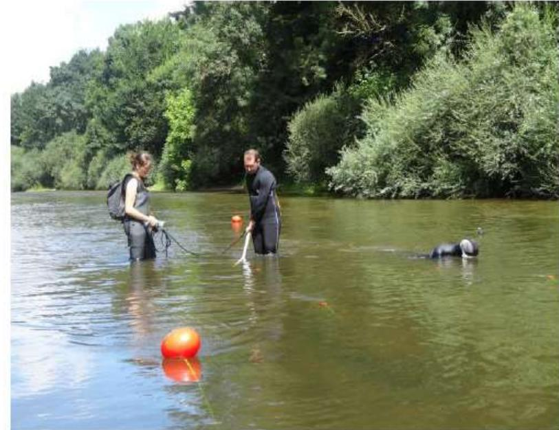
Figure 5 : recherche des individus par détecteur RFID (à gauche) et PMT (à droite), dans le cadre du suivi. Crédit photo Céline Mathieu
